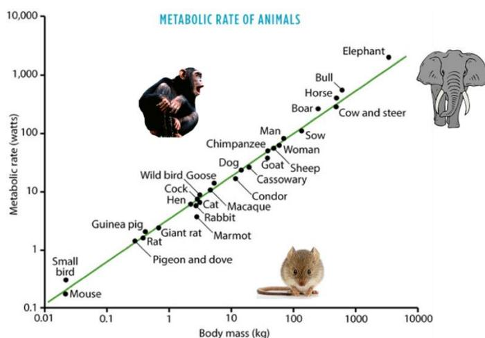
Wird eine Korrelation in der doppelt logarithmischen Darstellung linear, so handelt es sich original um eine Potenzfunktion.
